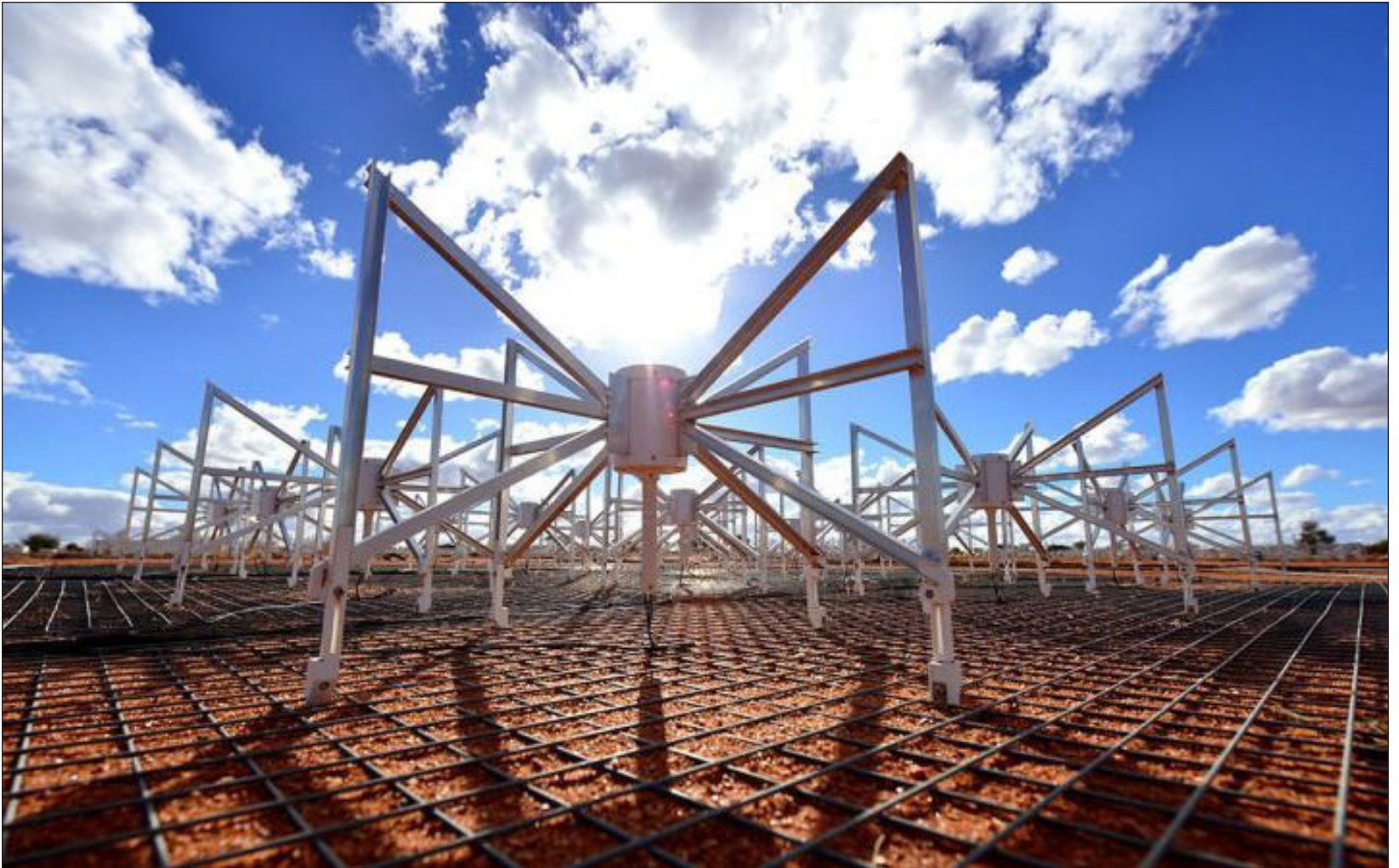
Antenas dipolo del telescopio Murchison Widefield Array, instalado en Australia Occidental. Foto Icrar/ Dragonfly Media
